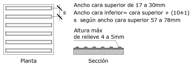
Imagen 06. Tipología de pavimentos tacto visuales según UNE-ISO 21542-2012
