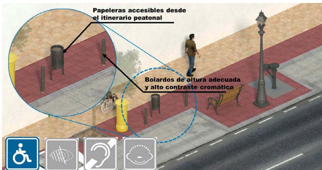
Imagen 10. Detalles de diseño de bolardos y papelera en banda de mobiliario
