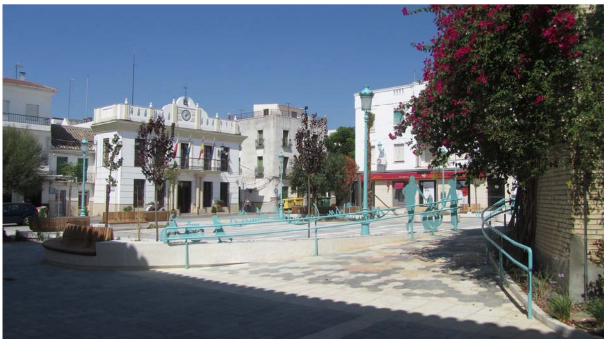
Imagen 03. Resolución de desniveles mediante el uso de rampa, acompañada de barandilla y de un diseño que permite hacerla atractiva a todos los usuarios, junto a escalera integradas en un mismo ambiente arquitectónico. Destacando el empleo de pavimentos tacto-visuales y contraste cromático con el entorno inmediato.
