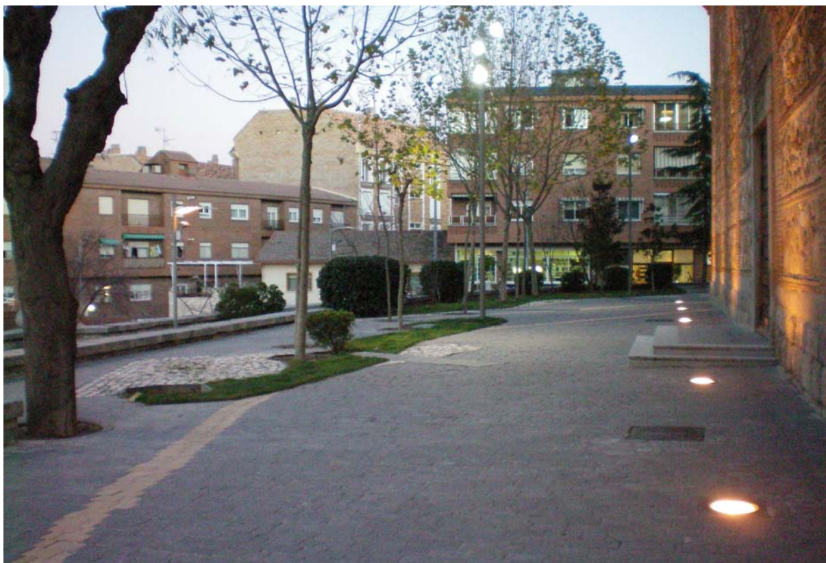
Imagen 14. Iluminación ornamental que singulariza el edificio en su entorno. Este tipo de focos deben situarse fuera del itinerario peatonal para evitar deslumbramientos.
