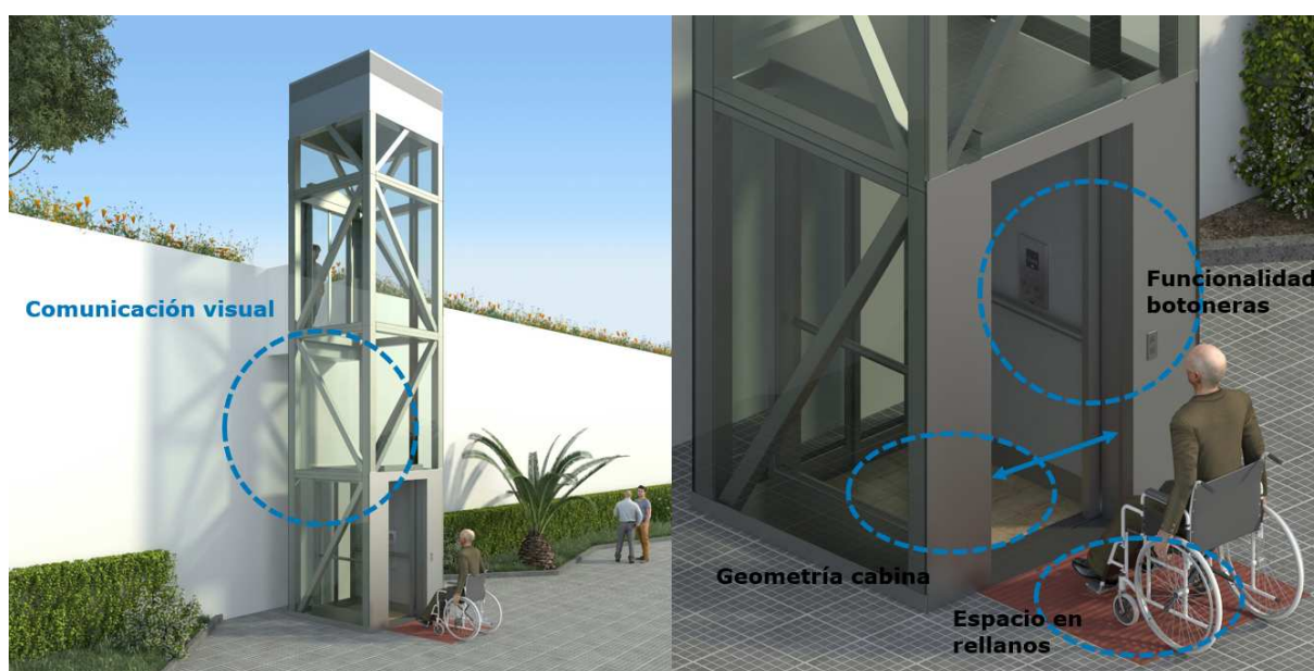
Imagen 02. Elementos a destacar en el diseño de un ascensor urbano
