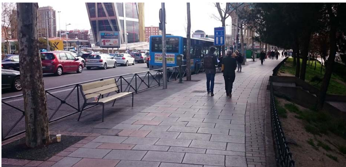
Imagen 10. Configuración en bandas en la plaza de Castilla. Los pavimentos diferenciados delimitan las bandas de mobiliario, itinerario peatonal accesible y, en este caso, una banda de borde de acera.
