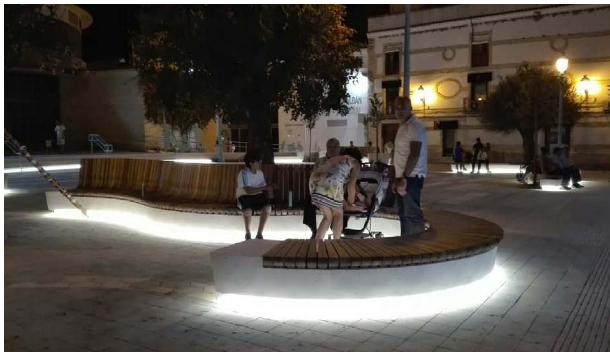
Imagen 16. Iluminación ornamental que permite la orientación en la deambulación nocturna en la Plaza de Andalucía. Evitando en todo momento los deslumbramientos y reforzándose con una iluminación ambiental en altura complementaria, en Montalbán de Córdoba
