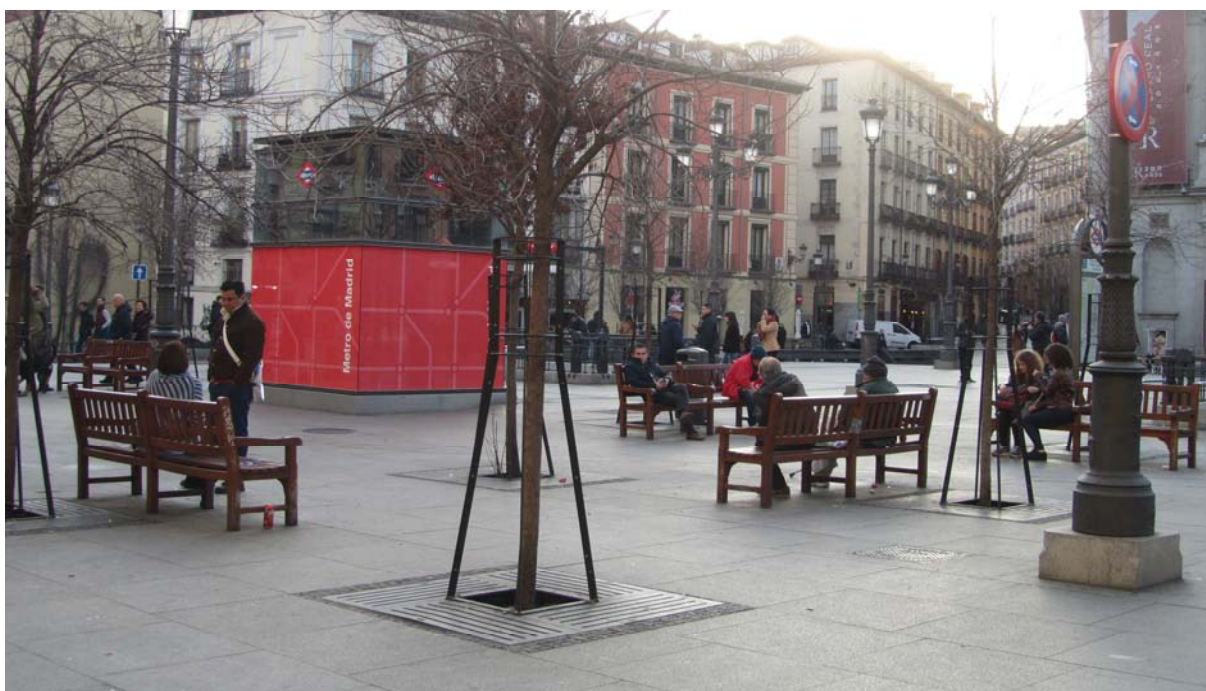
Imagen 20. Vista general de la disposición de diversos elementos de mobiliario urbano en la Plaza de Isabel II. Detalles varios de mobiliario, disposición de alcorque y solución de accesibilidad mediante rejilla y ubicación de los bancos accesibles.
