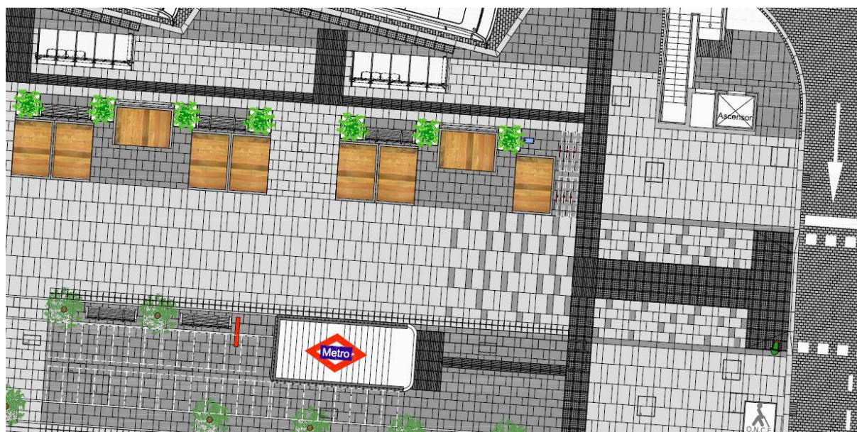
Imagen 07. Trazado de pavimentos tacto-visuales en el acceso a Metro conectado a la red de encaminamientos que comunica con las paradas de autobús y el paso de peatones. Proyecto plaza Felipe II
