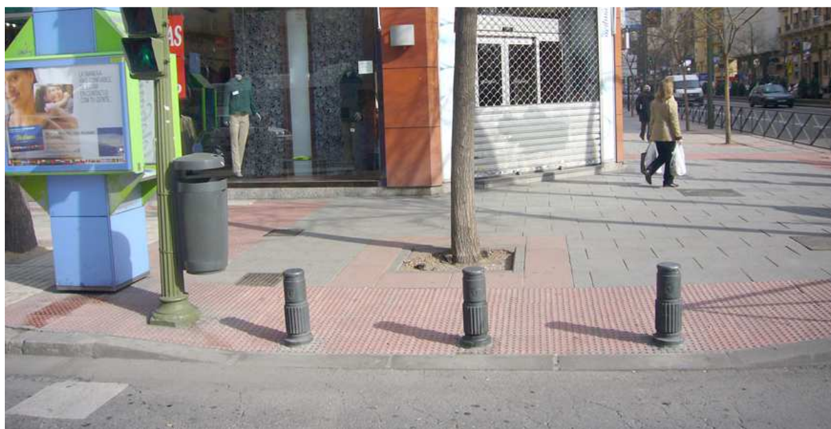
Imagen 20. Disposición en el entorno urbano A la hora de proyectar o construir un paso de peatones en entornos urbanos consolidados se evitará el mobiliario urbano o arbolado existente
