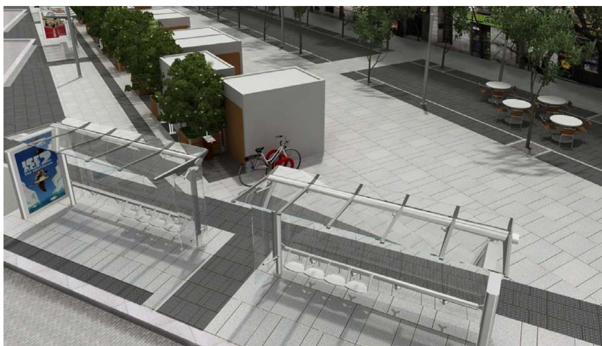
Imagen 09. Red de encaminamientos y señalización mediante pavimentos tacto visuales de las marquesinas de autobús urbano. Proyecto de reforma de la Plaza de Felipe II
