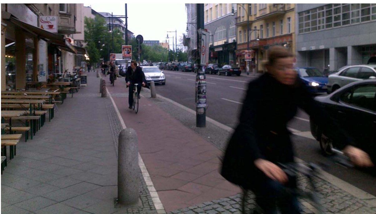
Imagen 06. Acera-bici en Bonn con franja de pavimento rugoso junto al itinerario peatonal
