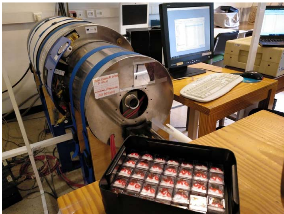
Figura 7. Magnetómetro superconductor 2G 755 de alta sensibilidad ( 10\text{-}12 \text{ A m}^2 ) con sistema desmagnetizador por campos alternos, utilizado para los análisis SIRM.
