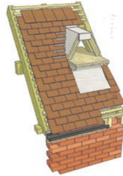
Colocación de caja nido de lechuza en cámara bajo cubierta, con acceso a través de tronera ( $400 \times 600 \times 400 \text{ mm}$  con acceso  $130 \times 130 \text{ mm}$ ). Una vez adecuada la tronera de acceso, el mismo puede dar a una cámara interior sin uso o a una caja nido integrada en la construcción.
